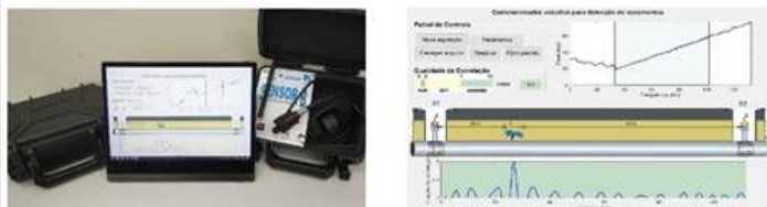
Figura 1 – Correlacionador de ruído de vazamentos desenvolvido pela UNESP. (a) Hardware; (b) Software
